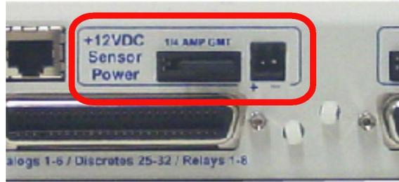
*Fig. 6.10.1. +12 VDC sensor power supply*
